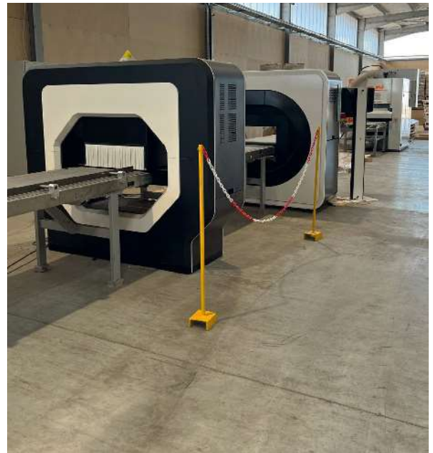
Installation de test avec les scanners Microtec Type Woodeye et la raboteuse OSI. Maurice Chalayer
